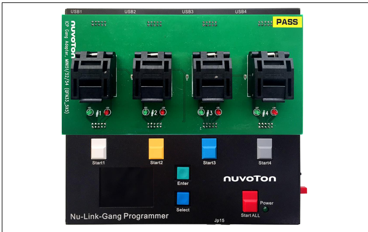
Figure 3-4 使用上板连接目标芯片
